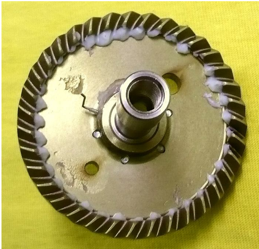
Getriebezahnrad. Der Fleck auf 11 Uhr Stellung ist kein Gießfehler sondern nur etwas Fett
