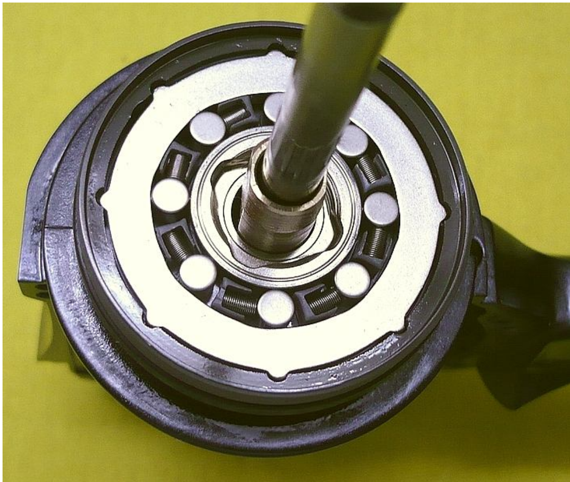
Rücklaufsperr ist von diverse Stellas bekannt. Daher erspart die in alle Einzelteile zu zerlegen
