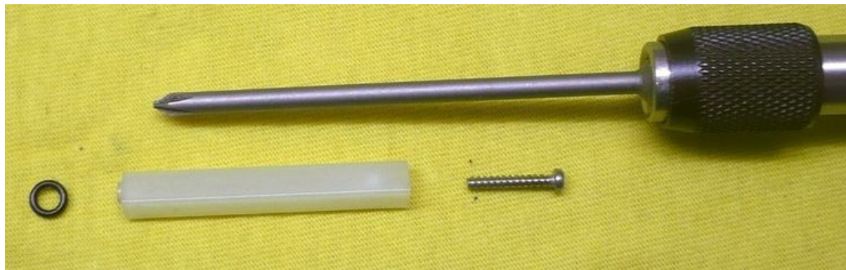
O-Ring, Führungsteil, Schraube, zum Lösen Kreuz Bit 0 L=75mm
