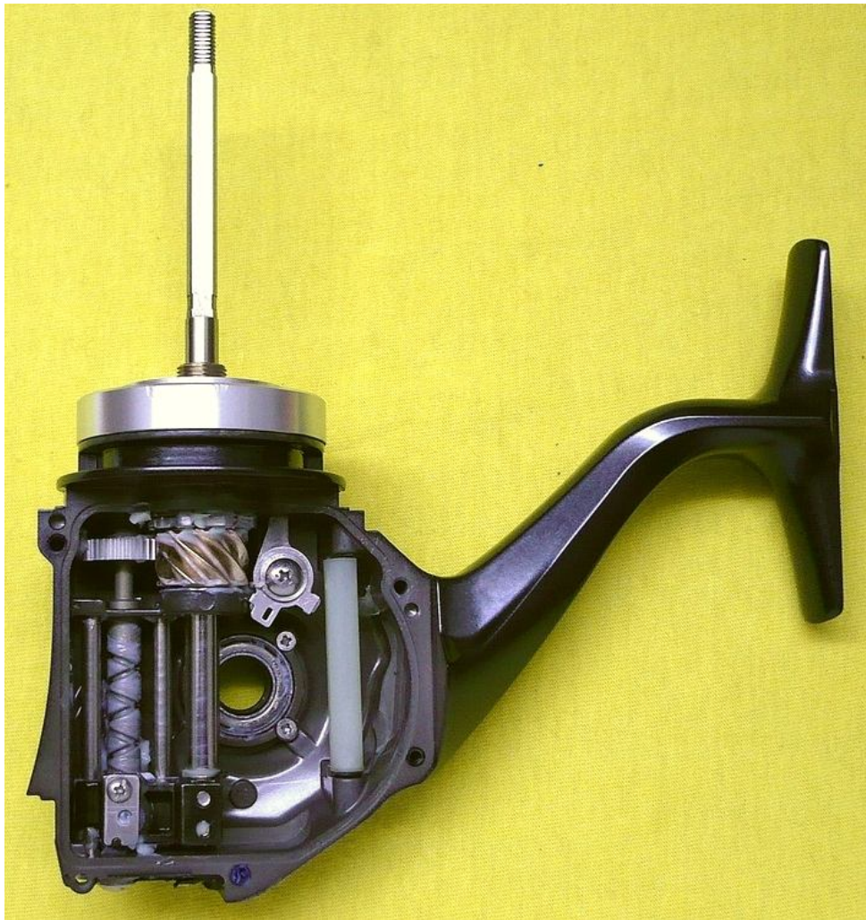
Blick in das Getriebe. Baugleich mit andere Stellamodelle
