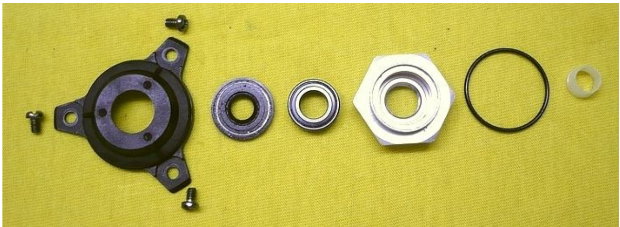
Alle Teile der Rotorbefestigung
