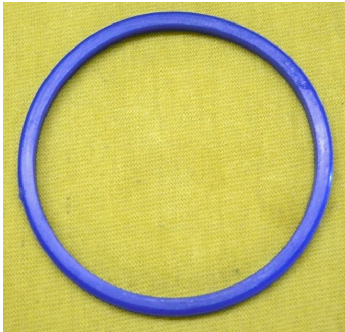
Dichtungsring für das obere Gehäuseteil. Festgestellt das bei Stellas die einige Jahre auf dem Buckel hatten dieser Ring weich und klebrig wird.
