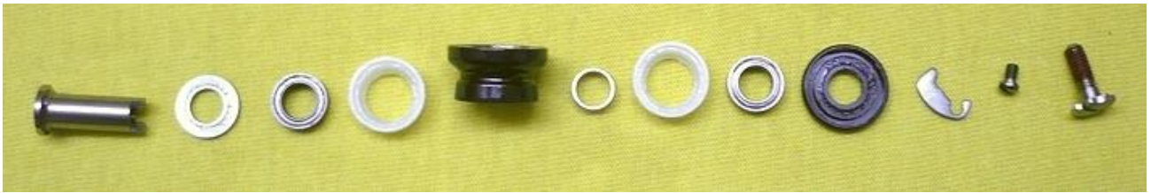
Alle Teile des Schnurlaufröllchens. War so gut wie trocken.
